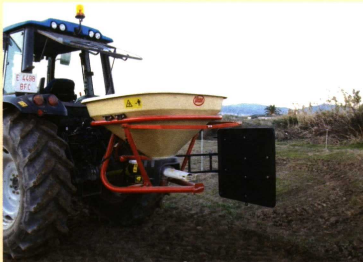
Foto 9. Plancha lateral deflectora que se utiliza con la abonadora pendular para el abonado en bordes.
