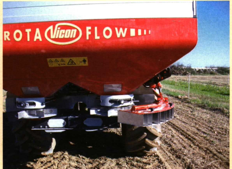
Foto 5. Detalle del TrimFlow, accesorio utilizado para el abonado en bordes. El abono lanzado por el disco de la derecha es recogido por el elemento y redistribuido en una menor anchura de trabajo.
