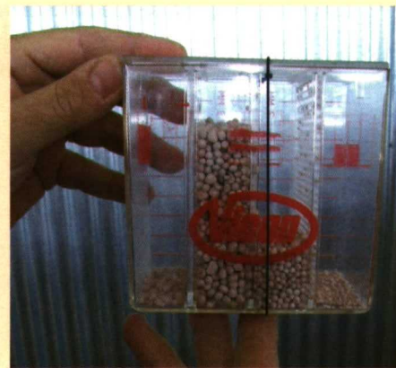
Foto 7. Comprobación de la granulometría del abono. Esta información resulta imprescindible para una adecuada regulación de la máquina.
