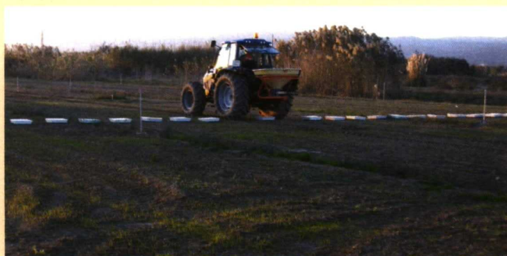
Foto 11. Momento de la determinación de la curva de distribución con la abonadora pendular.
