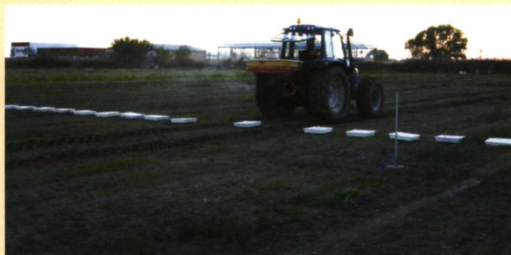
Foto 12. Utilización de la chapa deflectora para el abonado en bordes con la abonadora pendular.
