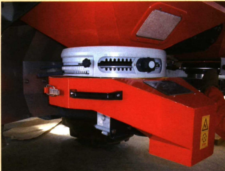
Foto 4. La Vicon RO-M incorpora un nuevo sistema de ajuste de dosis sencillo y claro, con dos escalas, una para el caudal y otra para el punto de caída del grano en el disco, todo ello incorporado en el sistema RotaFlow.
