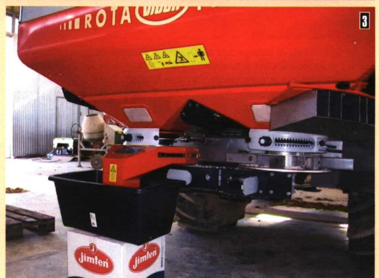
Foto 1. Proceso de regulación de las abonadoras en el nuevo laboratorio de maquinaria de la Universidad Politécnica de Cataluña. Foto 2. Abonadora centrífuga de dos discos Vicon RO-M durante las pruebas. Foto 3. El kit de calibración permite un fácil y ajustado control del caudal de la abonadora.
