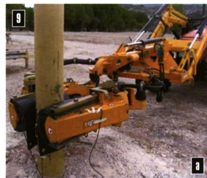
Foto 9. Formas del sistema de agarre: (a) tijera, (b) tenaza, (c) tres puntos.
