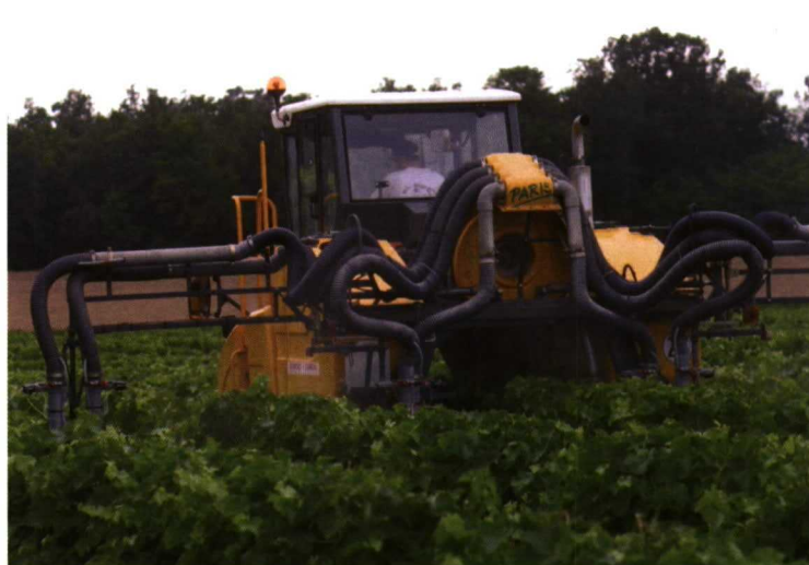
Foto 13. Vendimiadora equipada con pulverizador neumático.
