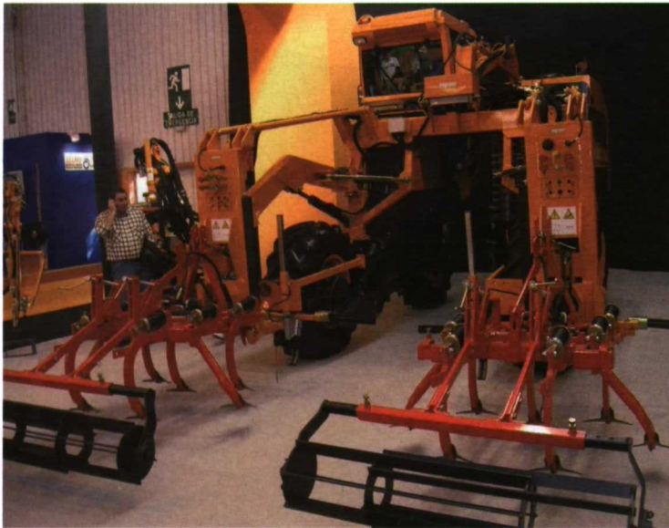
Foto 1. Cosechadora autopropulsada equipada con cultivador.
