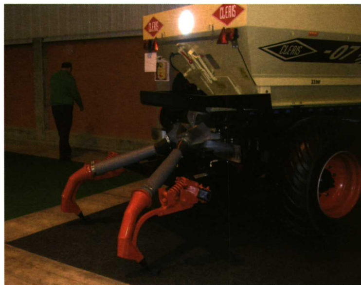
Foto 6. Abonadora con doble reja para localizar el abono.
