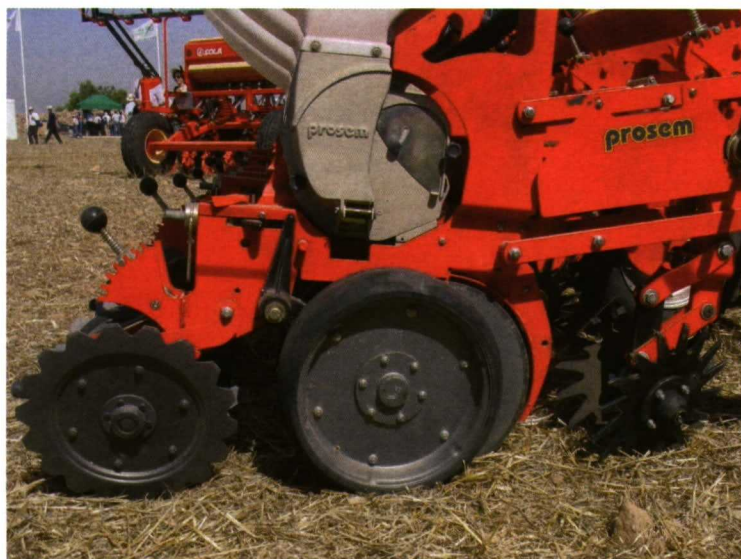
Foto 11. Detalle de barre-rastrajo o limpiador del surco de siembra.
