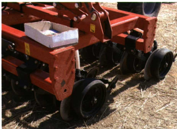
Foto 4 (Izquierda). Sembradora equipada con disco abridor único y rueda neumática de control de profundidad.
