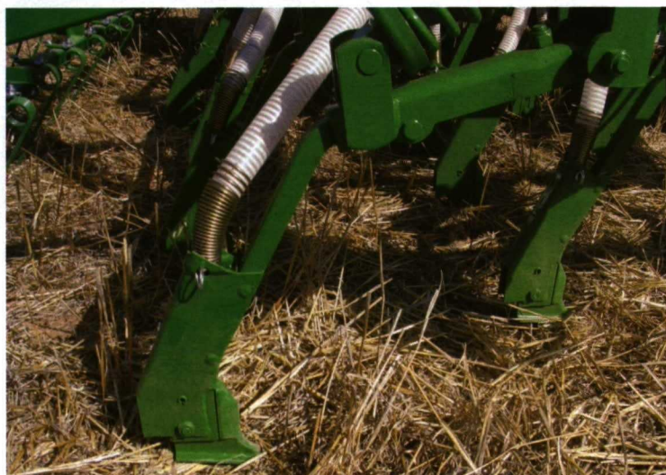
Foto 8 (arriba). Sembradora de rejas con rueda de cierre. Foto 9 (abajo). Sembradora de rejas con rastra trasera.
