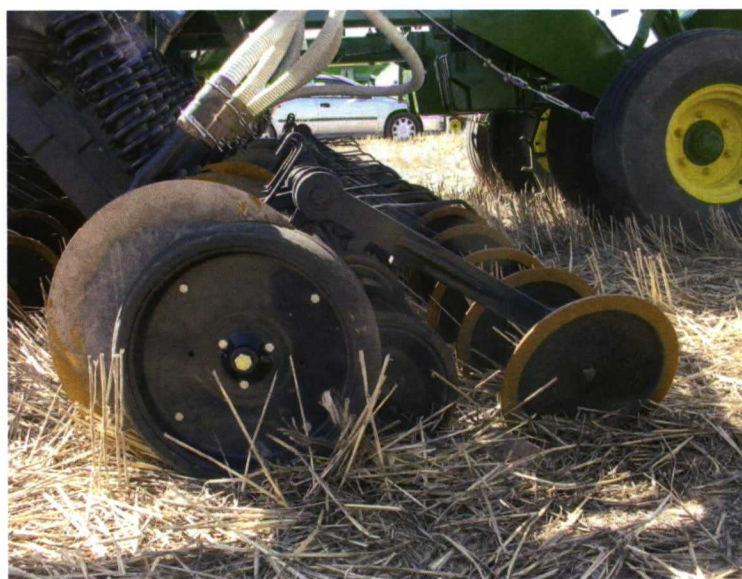
Foto 10. Tren de siembra con disco único, rueda fijadora, disco inclinado de cierre de surco al final y rueda neumática de control de la profundidad.
