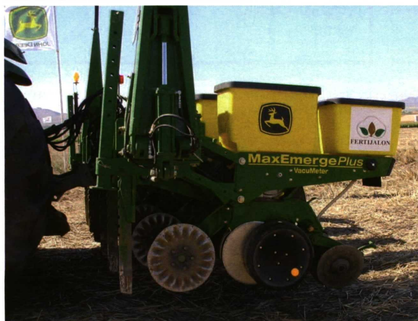
Foto 6 (arriba). Sembradora de chorrillo equipada con doble disco de apertura del surco.
