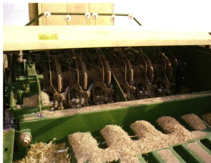
Foto 8. Dispositivo de atado con seis anudadores.
