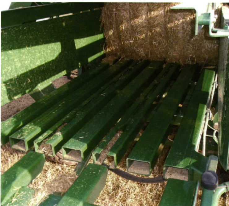
Foto 4. Canal de compresión.
