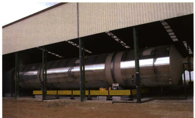
Foto 2. Trómel de secado rotativo de una industria deshidratadora de forraje.
