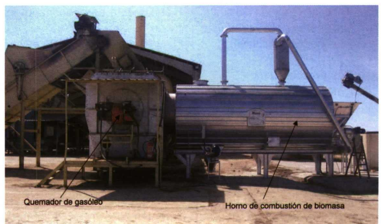
Foto 3. Horno de combustión de biomasa acoplado lateralmente a un horno de gasóleo, cuyo quemador (en rojo), se observa en primer plano.
