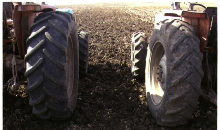
Foto 5. Ensayo comparativo entre neumáticos convencionales y de alta flotación.
