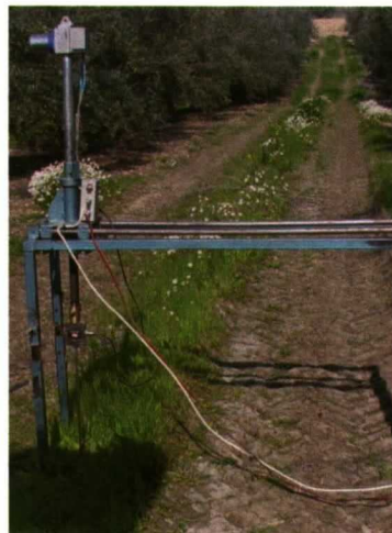
Foto 4. Penetrómetro de accionamiento eléctrico para la medida del Índice de Cono en la huella producida por el paso del neumático de un tractor.
