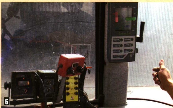
Foto 6. La gestión electrónica y el control de los parámetros corrió a cargo del Dual Control con el que iba equipado el Massey Ferguson que se utilizó durante la prueba.
