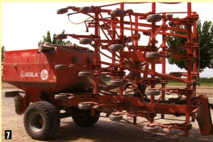
Foto 7. La sembradora SD-1504 en posición de transporte con una anchura máxima de 3 m.
