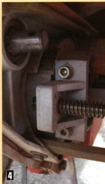
Foto 4. Detalle del elemento dosificador para semillas pequeñas.
