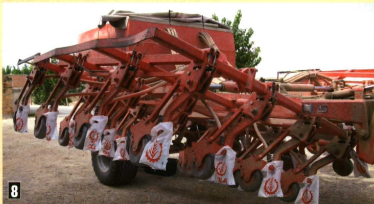
Foto 8. Aspecto de la máquina durante las pruebas de uniformidad de distribución entre botas.
