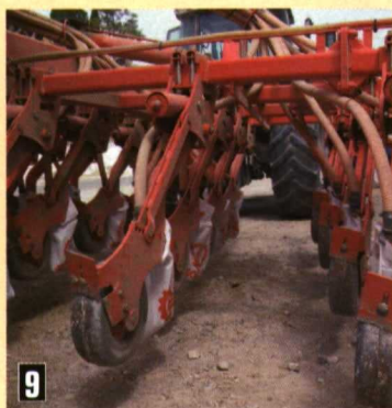
Foto 9. Detalle de la ubicación escalonada de las distintas líneas de siembra, para evitar obturaciones.
