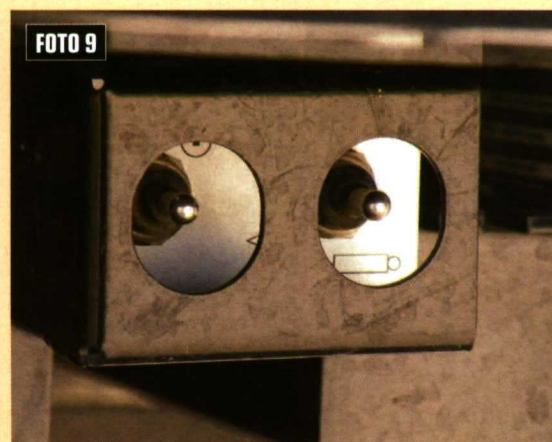
Foto 9. Mandos accesibles desde el suelo para regulación del sistema hidráulico del cabezal de vendimia. Foto 10. Radar para el control automático de la velocidad de avance.
