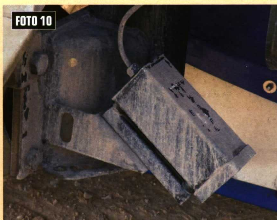
Foto 9. Mandos accesibles desde el suelo para regulación del sistema hidráulico del cabezal de vendimia. Foto 10. Radar para el control automático de la velocidad de avance.
