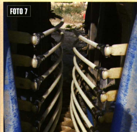
Foto 5. Cestas de recogida y transporte. Foto 6. Sistema de extracción superior ubicado junto a tolva. Foto 7. Detalle de los sacudidores.
