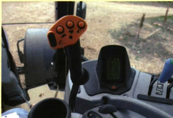
En el joystick de ambas series el operador puede cambiar de gama, accionar el sistema HTS y actuar sobre el elevador trasero.
