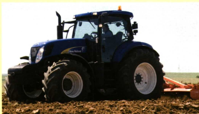
El sistema de Gestión de Potencia del Motor (*) permite a los tractores T6000 Grande y T7000 trabajar por encima de su potencia nominal con aperos a la toma de fuerza y en transporte.
