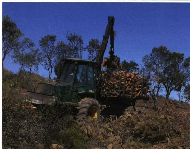
Arriba: Máquina procesadora cortando el pinar de resinero para liberar monte mediterráneo.
