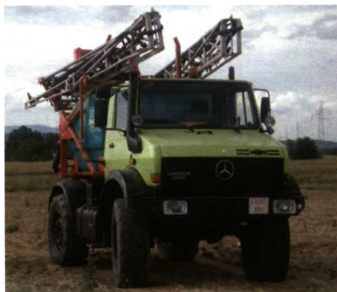
Para los tratamientos fitosanitarios y abonado confían en tres vehículos Unimog, dos de ellos de distribución de líquidos con 21 y 18 m de anchura de barra de tratamiento.
