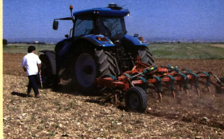
Detalle de las pruebas de determinación del resbalamiento de la rueda trasera.
