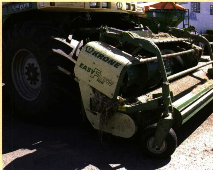
Foto 6. Cabezal Krone EasyFlow 3001 para recogida de hierba.
