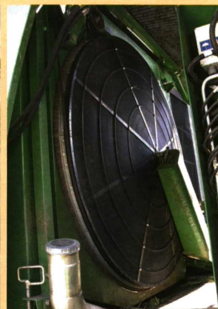
Foto 3. Detalle del enorme filtro del aire de refrigeración del motor con su cepillo aspirador rotativo.
