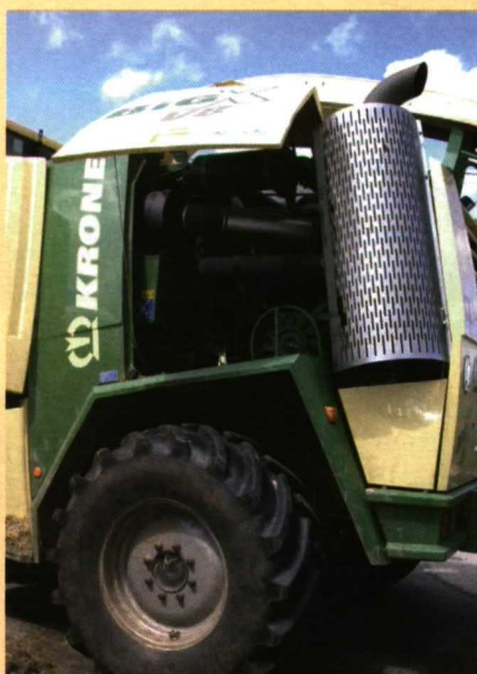
Foto 2. Alojamiento del motor Daimler-Chrysler de 8 cilindros en V en posición transversal.
