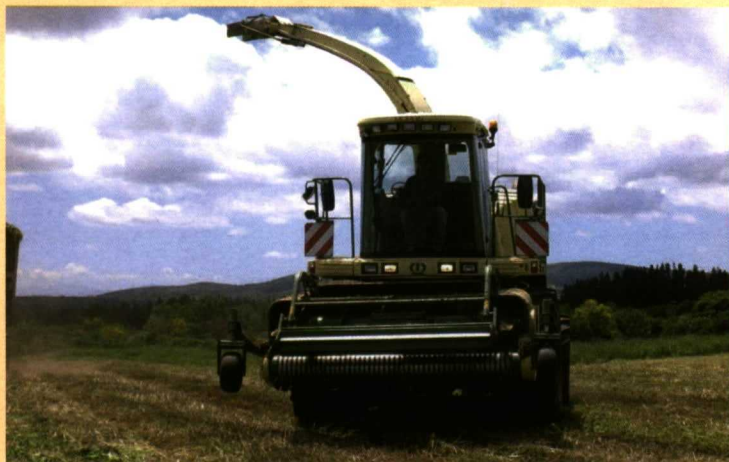
Foto 12. Cabina Command-Vision-Cab y cabezal EasyFlow 3001.
