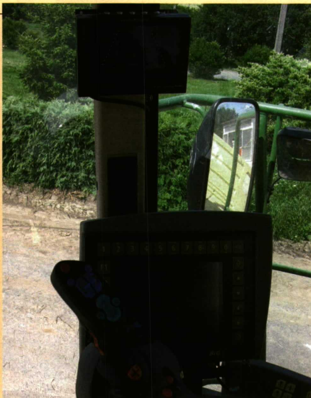
Foto 10. Palanca de mando, monitor EasyTouch (abajo) y monitor de la cámara trasera (arriba) en el interior de la cabina.
