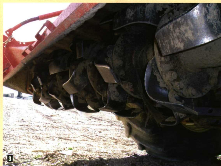
Foto 3. Rotocultor de eje horizontal con cuchillas curvas.
