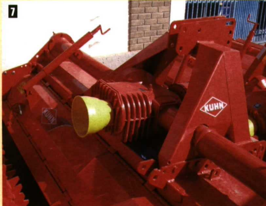
Foto 7. Enganche trasero con conexión a la toma de fuerza para añadir una sembradora.
