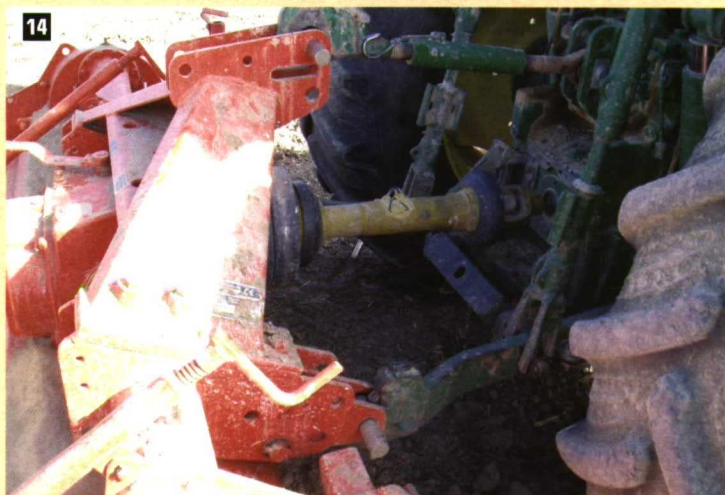
Foto 12. Discos laterales con sistema de regulación en altura.
