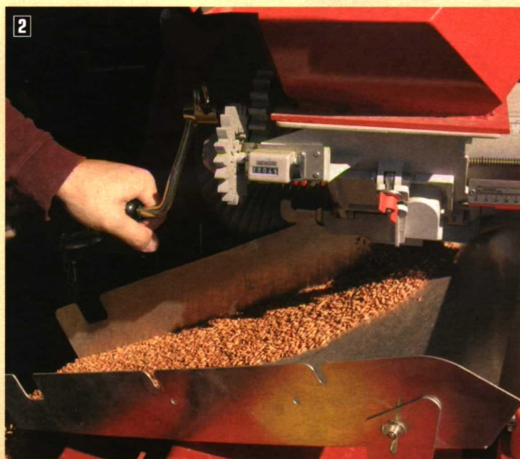
La facilidad de uso y la muy buena accesibilidad del sistema de regulación de la dosis de siembra, infinitamente mejorado con respecto a modelos anteriores, es una de las novedades del equipo.
