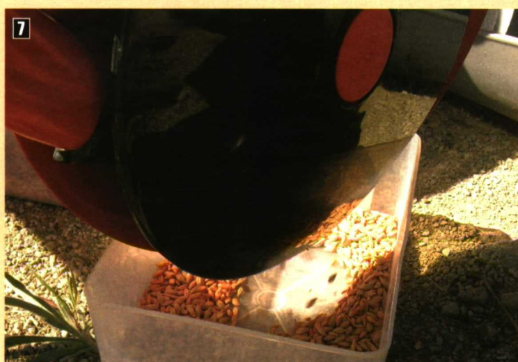
Detalle de la prueba de uniformidad de distribución entre las distintas líneas de siembra.
