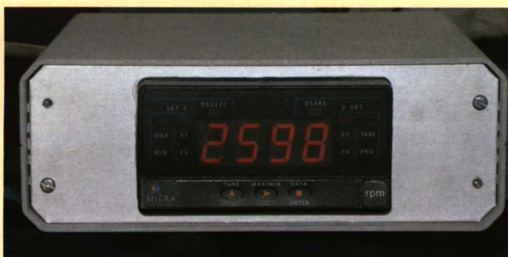
Tacómetro auxiliar para medición de la velocidad del motor.
