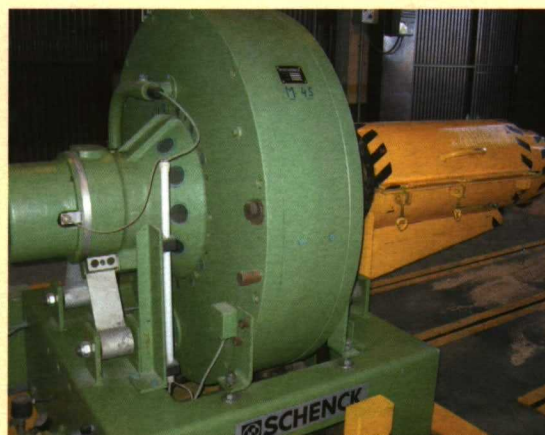
Arriba: detalle del freno dinámico métrico usado en los ensayos. Abajo: medición auxiliar de la temperatura del líquido refrigerante.
