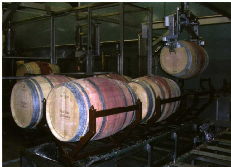
Tren de vaciado, lavado y llenado de barricas, desarrollado por el equipo de la bodega Real Sitio de la Ventosilla.
