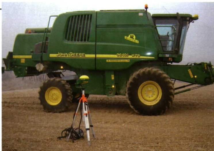
Cosechadora 9640i WTS con guiado automático Autotrac y sistema de gestión para la toma de datos de rendimiento y humedad.
