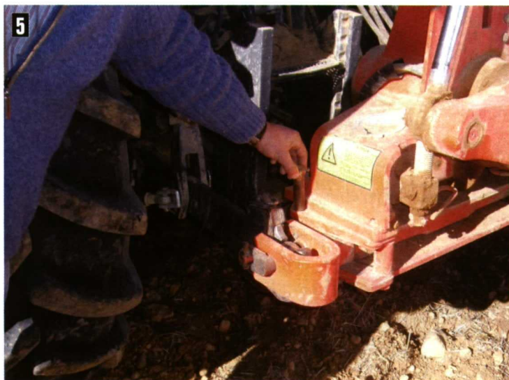
Foto 5. Bulones para limitar el movimiento horizontal en transporte.
