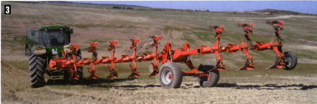
Foto 3. Arado de vertedera semisuspendido o arrastrado. Foto 4 (abajo). Enganche del arado a los tres puntos del tractor.
