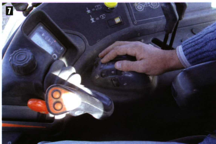
Foto 7. Accionamiento del sistema hidráulico desde la cabina para modificar la profundidad de trabajo en arados suspendidos.
