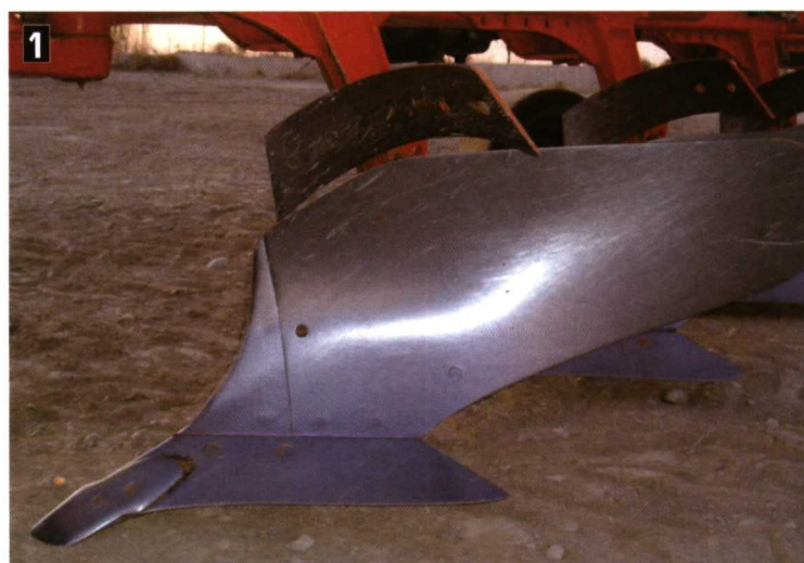
Foto 1 (izda.). Reja y vertedera de un cuerpo de arado.
