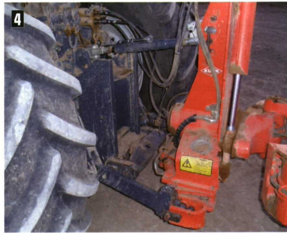
Foto 3. Arado de vertedera semisuspendido o arrastrado. Foto 4 (abajo). Enganche del arado a los tres puntos del tractor.
