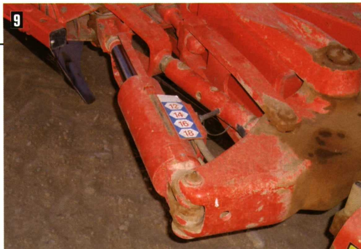
Foto 9. Sistema de regulación de la anchura de trabajo.
