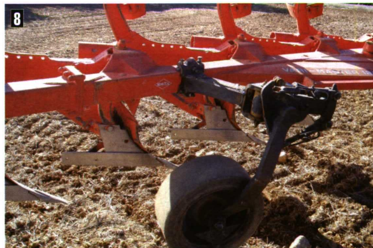
Foto 8. Rueda de apoyo para regular la profundidad de trabajo en arados semisuspendidos.
