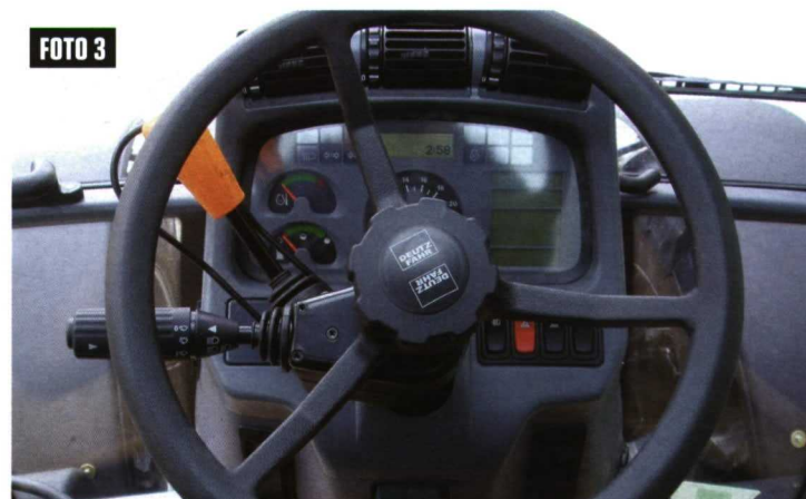
Foto 2. Vista de los diferentes mandos para el control de las principales funciones del tractor. Color rojo para la transmisión, azul para las tomas hidráulicas auxiliares, verde para el elevador y amarillo para la toma de fuerza.
