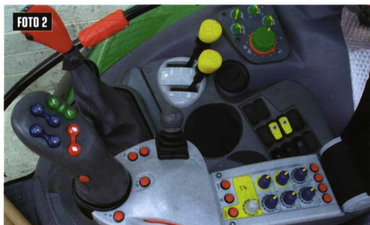
Foto 2. Vista de los diferentes mandos para el control de las principales funciones del tractor. Color rojo para la transmisión, azul para las tomas hidráulicas auxiliares, verde para el elevador y amarillo para la toma de fuerza.
