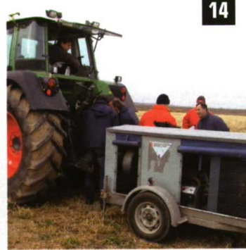
Foto 10. Medida del radio de giro. Foto 11. Medida del anticipo del tren delantero y del radio dinámico. Foto 12. Vista frontal del modelo 714 sin sistema hidráulico delantero. Foto 13. Vista del modelo 415 con sistema hidráulico delantero y brazos elevadores. Foto 14. Ensayo de potencia con el freno dinamométrico.
