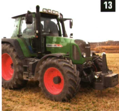
Foto 10. Medida del radio de giro. Foto 11. Medida del anticipo del tren delantero y del radio dinámico. Foto 12. Vista frontal del modelo 714 sin sistema hidráulico delantero. Foto 13. Vista del modelo 415 con sistema hidráulico delantero y brazos elevadores. Foto 14. Ensayo de potencia con el freno dinamométrico.
