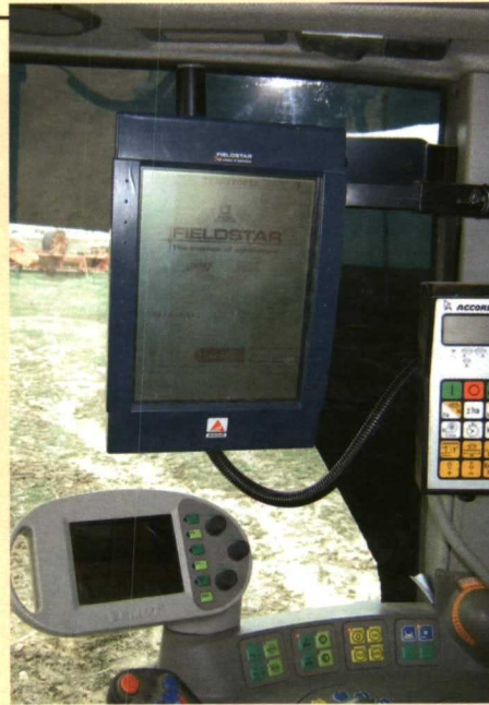
Su flota de máquinas dispone del sistema Fieldstar del Grupo Agco con el que realizan mapas de rendimiento y humedad de la cosecha, así como de presencia de plagas en lugares determinados de la parcela.
