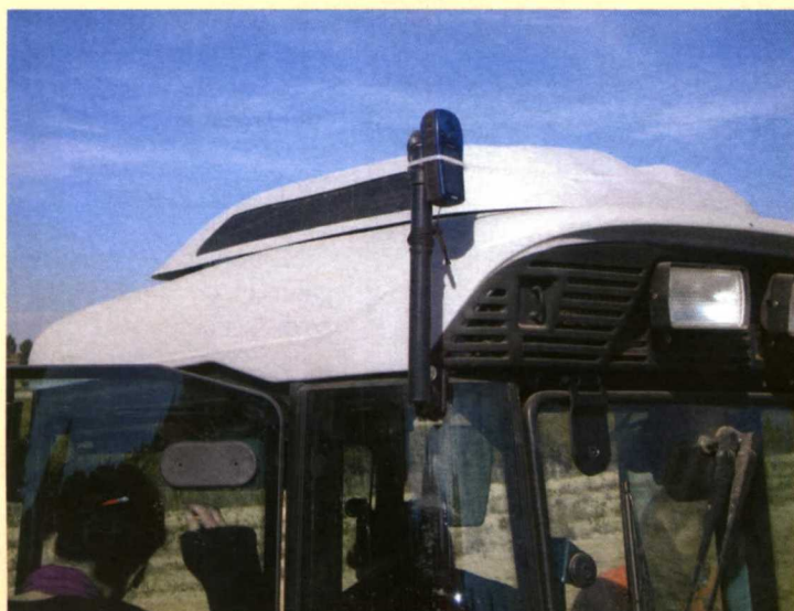
Foto 5. Detalle del receptor GPS colocado en el tractor durante las pruebas.
