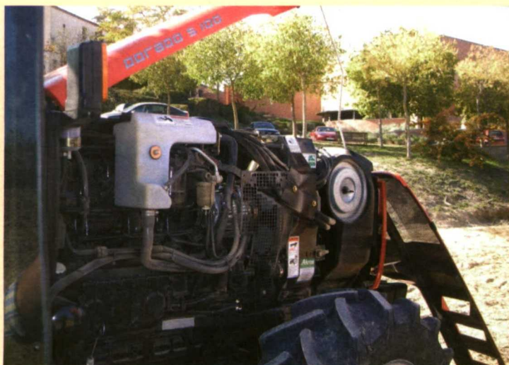
Foto 7. Todos los elementos del mantenimiento del motor situados en el mismo lado y con un fácil acceso.
