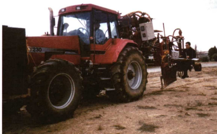
Foto 5. Imágen del prototipo desarrollado por el Instituto de Automática Industrial. Este sistema permite plantar tres líneas de vid o frutales sin referencias previas sobre el terreno; y dispone de un sistema de guiado y de posicionamiento de la cepas mediante tecnología DGPS.
