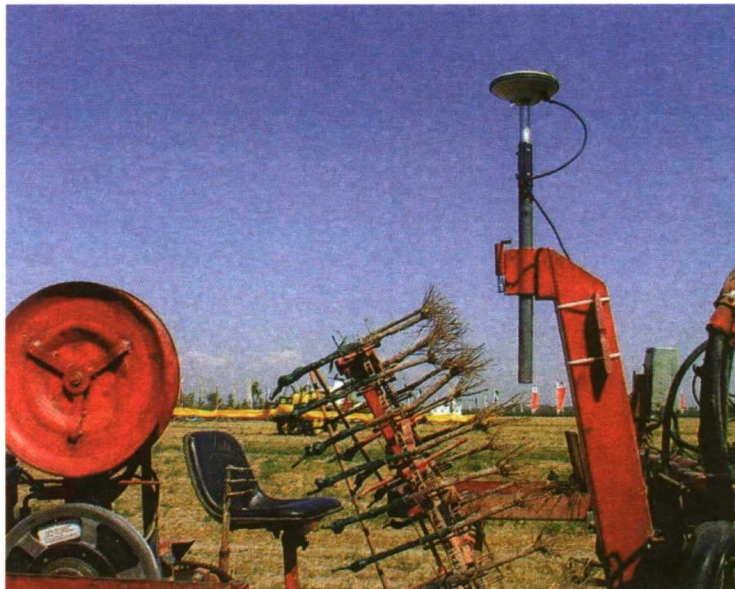
Foto 2. Algunas aplicaciones donde el uso de GPS embarcado proporciona un sistema completo y fiable para la plantación de frutales y vid.
