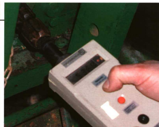
Foto 4. Abonadora arrastrada en la EECAS de Palencia. Foto 5. Cajas de tamices para determinar el tamaño y porcentajes volumétricos de los gránulos de abono. Foto 6. Comprobación de las rpm de la toma de fuerza.
