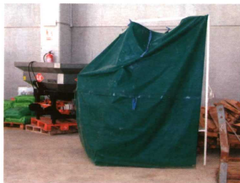
Foto 3. Cabina de medición de caudales.
