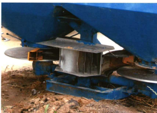
Foto 7. Deflector alterado y no corregido.
