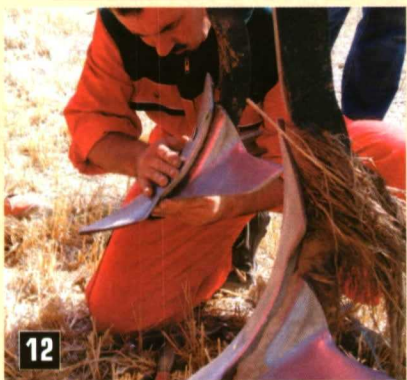
Foto 10. Resultado del enterrado del estiércol en parcela. Foto 11. Trabajo de labor a 15 cm de profundidad sobre rastrojo de cebada. Foto 12. Modificación de la posición relativa entre reja y alas. Foto 13. Resultado de la labor sobre rastrojo de cebada.
