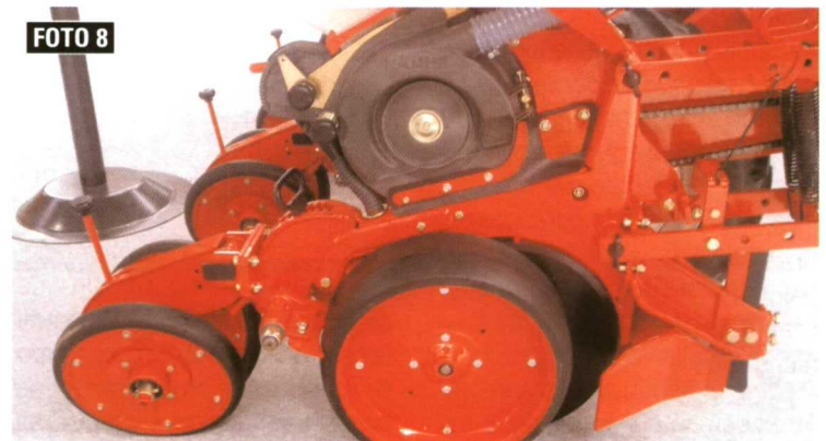
Foto 8. Cuerpo de siembra de una sembradora neumática monograno con sistema de apertura de disco y sistema de cierre mediante rueda compactadora.
