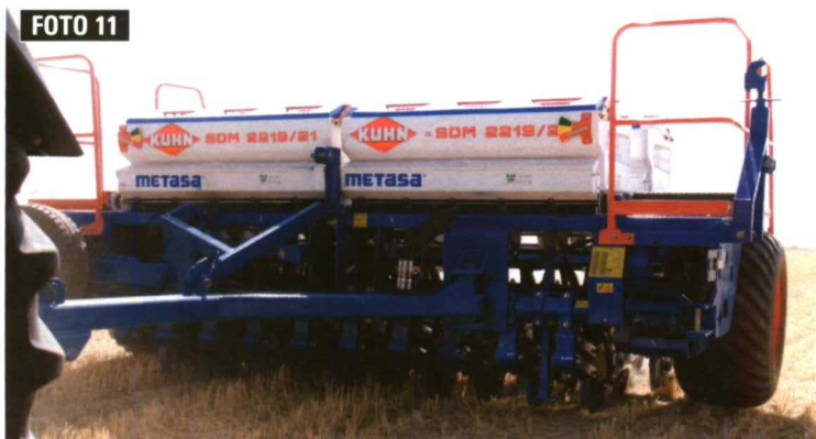
Foto 11. Cada vez más sembradoras presentan la posibilidad de incorporar microgránulos fertilizantes en la línea de siembra. Foto 12. Proceso de calibración para comprobar que la dosis de siembra prevista es correcta.
