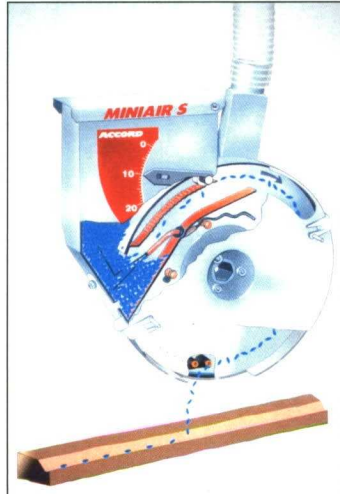
Foto 4. Sistema dosificador de rueda dentada en sembradora a chorrillo.
