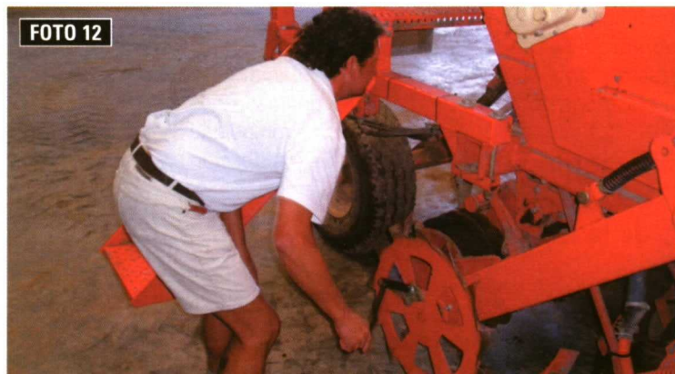
Foto 11. Cada vez más sembradoras presentan la posibilidad de incorporar microgránulos fertilizantes en la línea de siembra. Foto 12. Proceso de calibración para comprobar que la dosis de siembra prevista es correcta.
