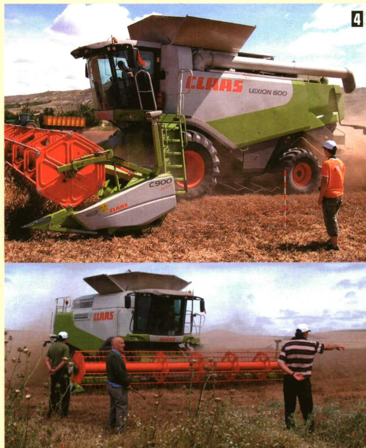
Foto 4. Referencia del jalón para definir espacio y tener referencia para la toma de tiempos.
