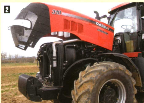
Foto 2. Motores de elevadas prestaciones, con un régimen nominal bajo (2.000 rpm) permite reducir ruido, vibraciones y desgaste, con una potencia de 345 CV.
