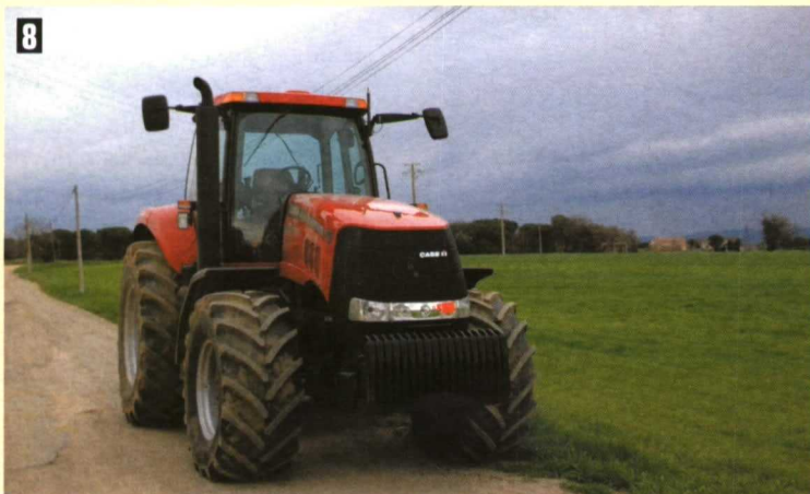
Foto 8. El valor obtenido en la prueba de determinación del adelanto del eje delantero indica un anticipo del eje delantero prácticamente nulo, lo que pone de manifiesto la elevada sincronización de la tracción en ambos ejes.
