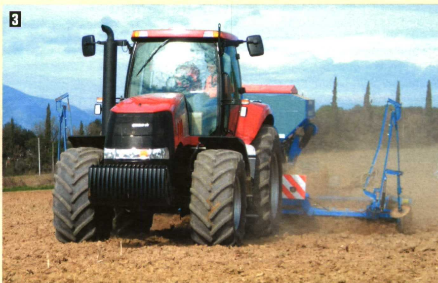
Foto 2. Motores de elevadas prestaciones, con un régimen nominal bajo (2.000 rpm) permite reducir ruido, vibraciones y desgaste, con una potencia de 345 CV.
