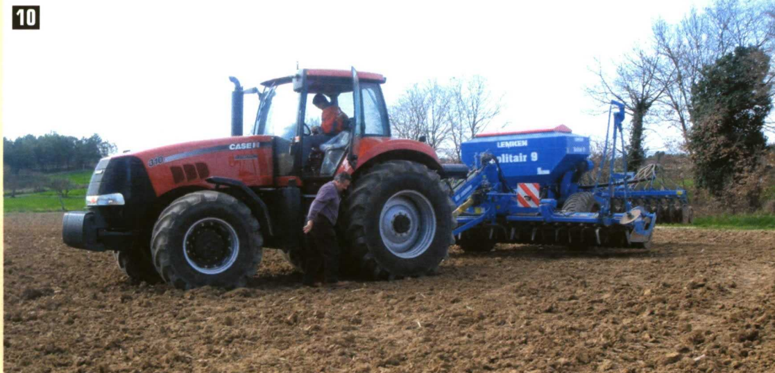
Foto 9. Dadas las características técnicas del apero empleado, las condiciones de la parcela, y el criterio del agricultor colaborador, se procedió a realizar las pruebas por duplicado. En primer lugar para una velocidad de avance baja (4 km/h) y en segundo lugar con una velocidad de avance elevada (7 km/h) mucho más acorde a las posibilidades y prestaciones del conjunto tractor-apero.
