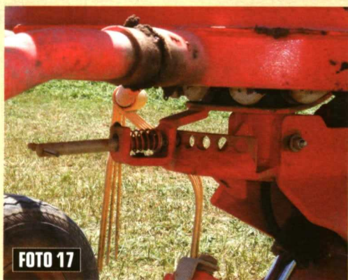
Foto 14. Regulador manual de la altura de trabajo del rastrillo TWIN 470-DH. Foto 15. Rastrillo hilerador TWIN 605-ED. Foto 16. Regulador de altura de los rastrillos de doble rotor. Foto 17. Sistema regulador de la excéntrica de los rotores. Foto 18. Brazos del rotor comandados por la excéntrica. Foto 19. Rastrillo hilerador TWIN 745-VS.
