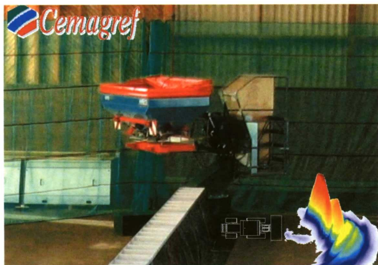
Banco de pruebas para la medición de rendimientos de esparcido de abonos de Cemagref.
