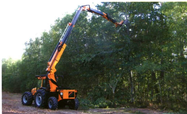
Segadora-desbrozadora con brazos articulados de SMA.
