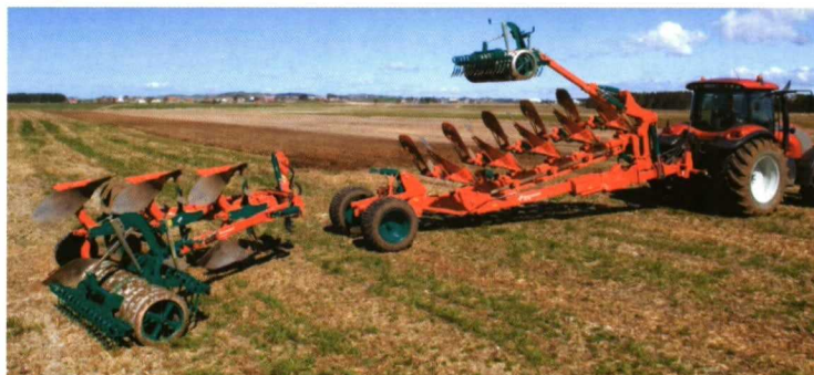
Sistema "3 en 1" arado semicargado de Kverneland.
