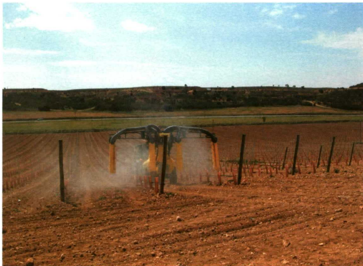
Fotos 5 y 6. El incremento de la capacidad de trabajo se logra de diversas formas. Entre ellas, destaca el tratamiento de más hileras por pasada en el caso de la viña.
