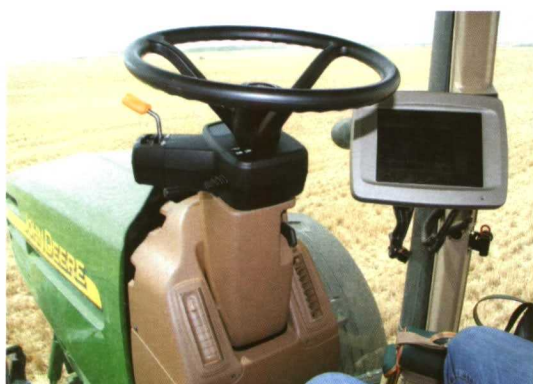
Foto 13. Los distintos sistemas de regulación van siendo substituidos, a medida que más tractores van equipados con ordenador de a bordo, por sistemas manejados por este ordenador.
