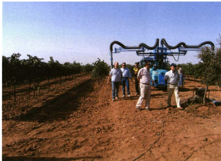
Fotos 5 y 6. El incremento de la capacidad de trabajo se logra de diversas formas. Entre ellas, destaca el tratamiento de más hileras por pasada en el caso de la viña.
