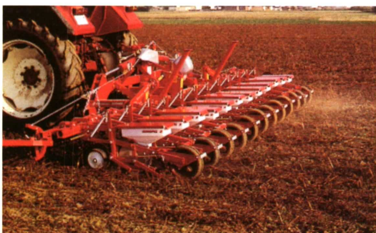
Foto 5. Sembradora mecánica de precisión sobre restos vegetales.
