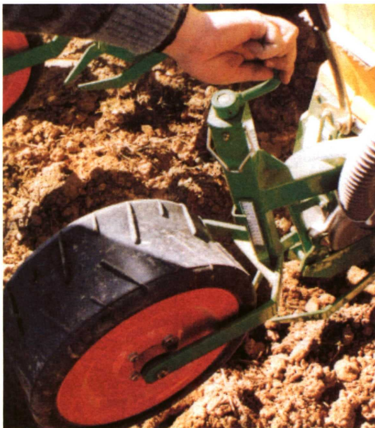
Foto 7. Control de la profundidad de siembra mediante manivela.
