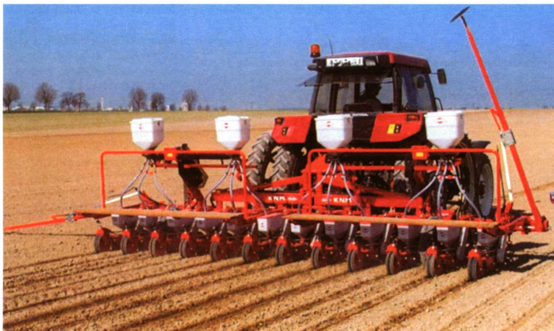
Foto 1. Sembradora monograno mecánica con dispositivo de depósito de microgranulados.
