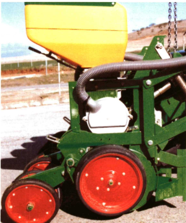
Foto 6. Detalle del tren de siembra directa abresurco de disco y reja para piedras.
