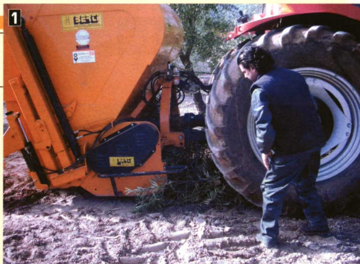
Foto 2. Vista del tren de picado y del inversor.
