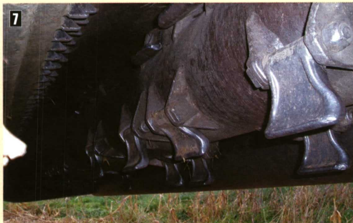
Foto 7. Detalle de los martillos de la picadora Serrat T-4000.
