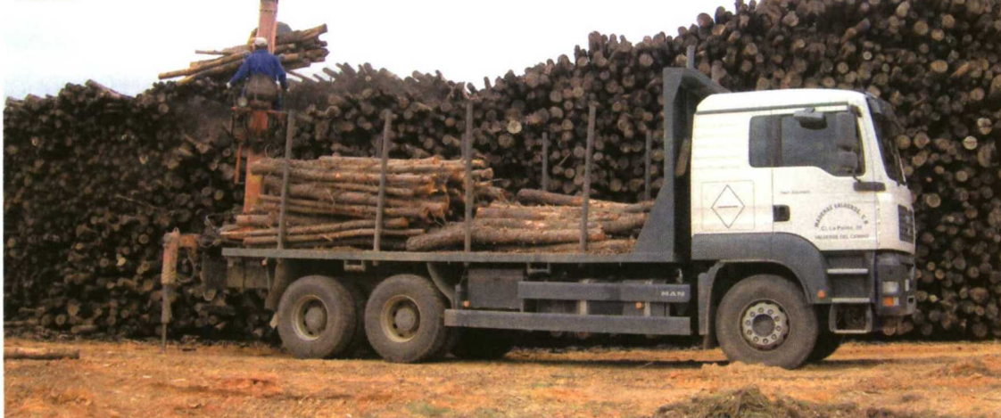
Foto 5. Camión con grúa mientras descarga en parque de madera de fábrica.
