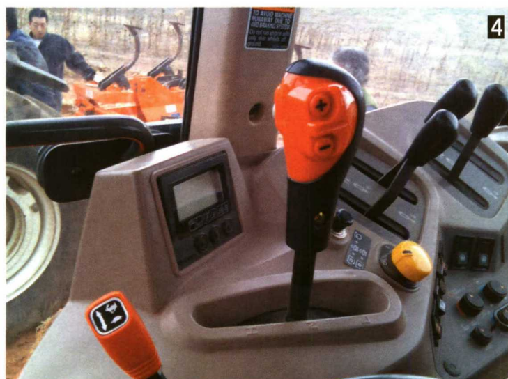
4. Palanca de cambios (cambio asistido de 8 velocidades) en el tractor M125X.
