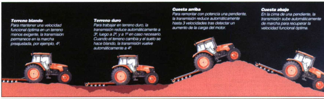
FIGURA 3. Función del modo automático en el tractor M125X.
