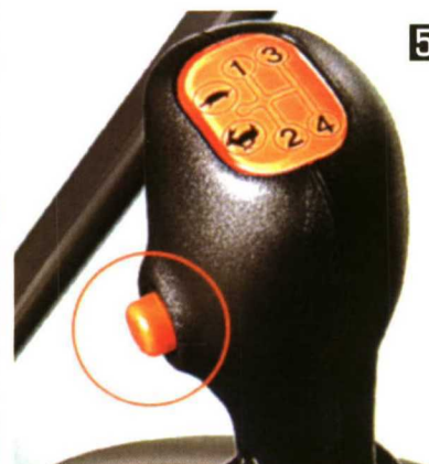
4. Palanca de cambios (cambio asistido de 8 velocidades) en el tractor M125X.
