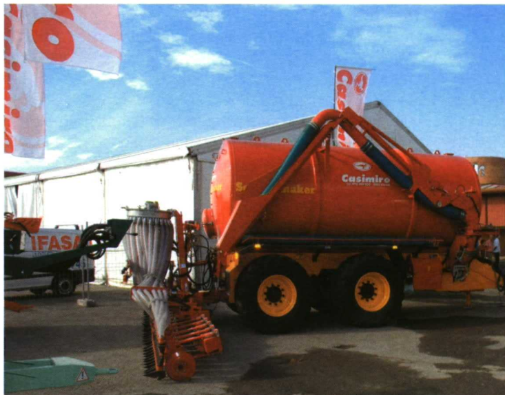
El enterrado de purines se impondrá totalmente en los próximos años. Los equipos tienen gran capacidad, un buen tren de rodadura y eficaces sistemas de control de las cantidades aplicadas.
