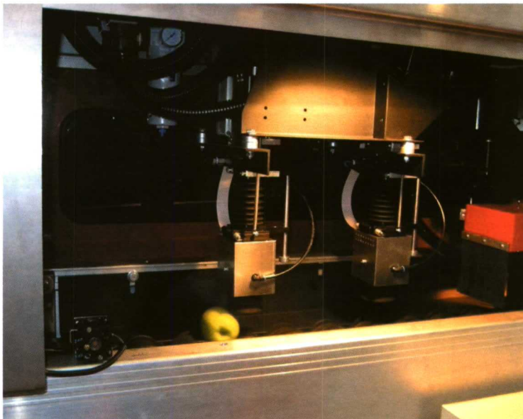
Foto 9. Sensor acústico para la medida de firmeza.
