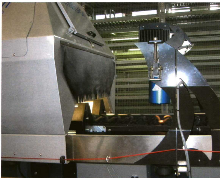
Foto 8. Sensor óptico para la medida de calidad interna por reflectancia.
