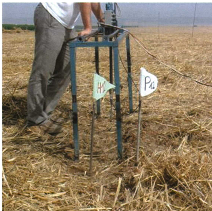
Foto 1. Ensayo de resistencia a la penetración con penetrómetro eléctrico.
