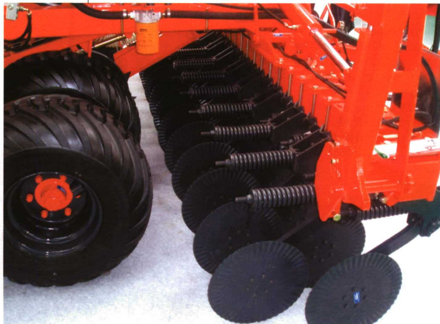
Foto 3. Disco ondulado de corte de residuos e inicio del surco.
