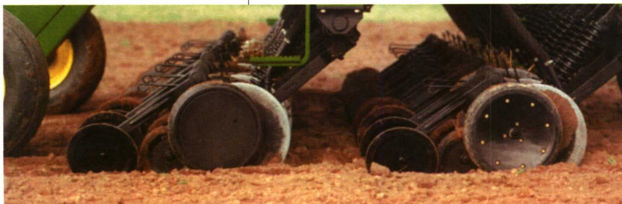
Foto 5. Tren de siembra con abresurcos de disco simple, rueda lateral de control de profundidad, rueda de asentado y rueda de tapado de surco.
