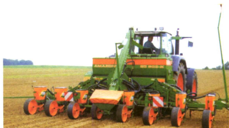
Foto 8. Sembradora neumática monograno.
