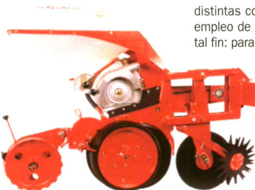
Foto 12. Cuerpo de siembra de una sembradora neumática monograno con limpiador de residuos estrellado y cuchilla circular previos a los discos abridores del surco.
