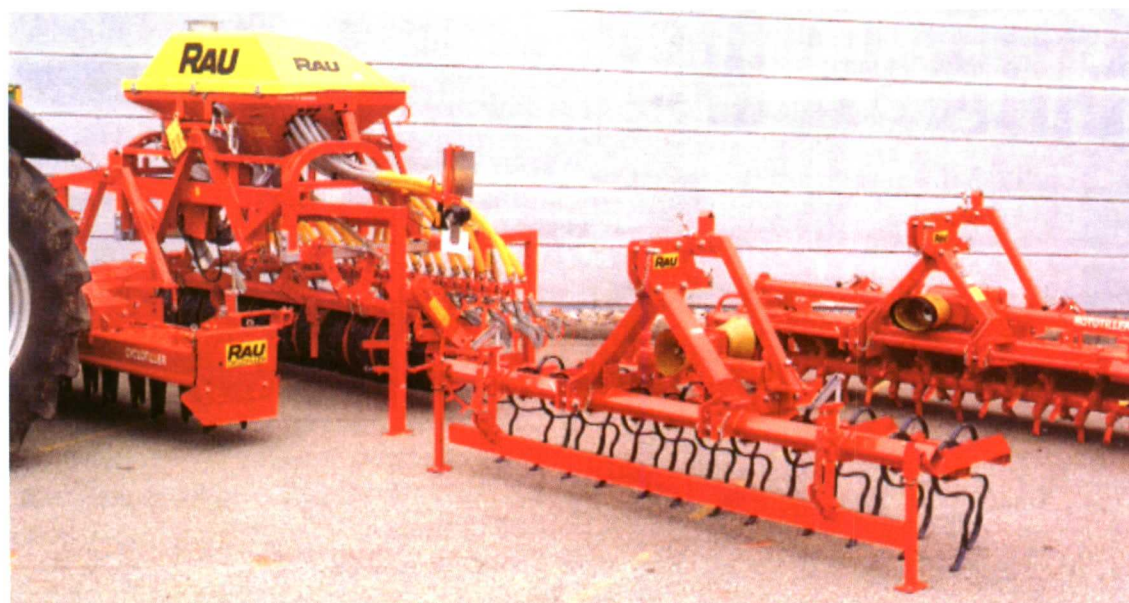
Foto 13. Sembradora neumática a chorrillo con apero para preparación del suelo. Sistema de triángulo para acoplamiento de aperos de preparación del suelo.
