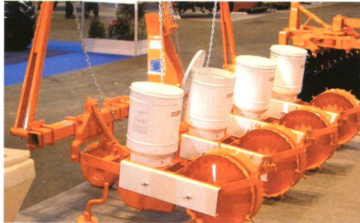
Foto 10. Sembradora mecánica monograno.
