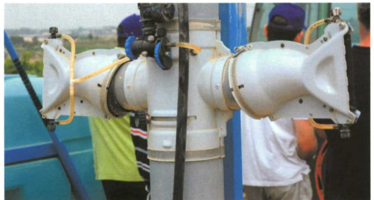
Detalle de los reguladores de caudal y de la válvula antigoteo.
