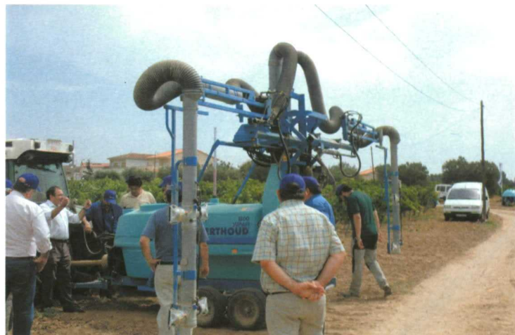
Arriba. El difusor Airmist doble, con una protección frente a choques contra el suelo. Centro y abajo. El Supair 1500 en la viña, a punto de iniciar el tratamiento.
