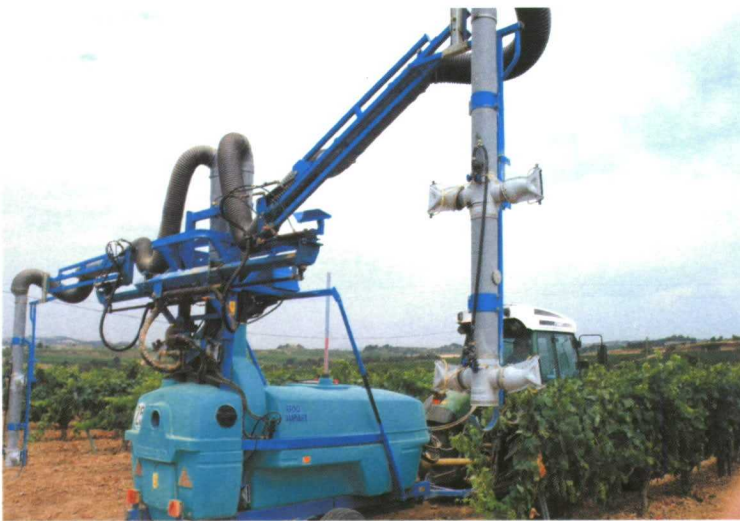
Detalle de la fase de plegado del pórtico.
