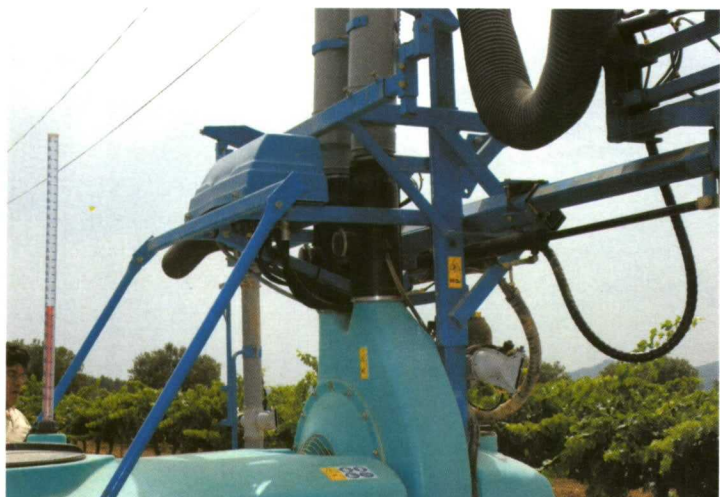
El sistema de distribución, perfectamente protegido. Los mandos operativos están en la cabina.
