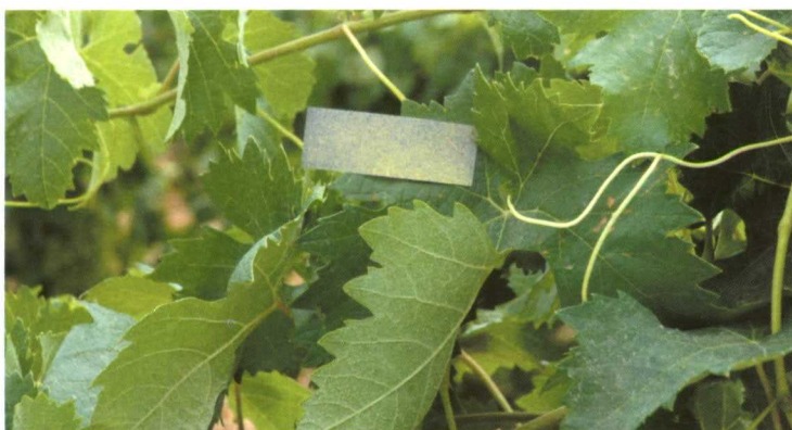
Distintas tomas de los papeles hidrosensibles después de una de las pasadas de la máquina. Las ligeras diferencias deben atribuirse a la situación concreta, y seguramente al mismo hecho de la prueba, pero debemos admitir que todas ellas reflejan un nivel de cobertura excelente.
