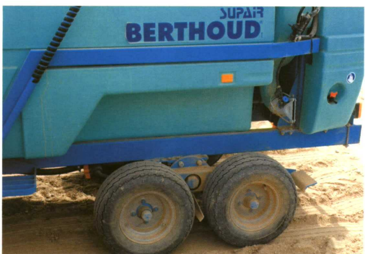
El tren de rodadura, con las ruedas en tándem, que asegura una gran estabilidad.
