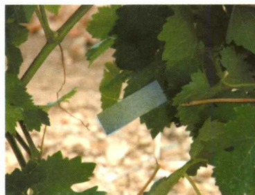
Distintas tomas de los papeles hidrosensibles después de una de las pasadas de la máquina. Las ligeras diferencias deben atribuirse a la situación concreta, y seguramente al mismo hecho de la prueba, pero debemos admitir que todas ellas reflejan un nivel de cobertura excelente.
