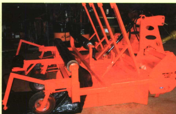
El rotocultivador FR prepara el terreno y hace dos caballones a la vez, con goma de goteo y plástico.
