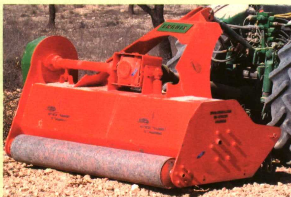
La trituradora modelo TRO está diseñada para terreno forestal con una anchura de trabajo que alcanza los 2,8 m.
