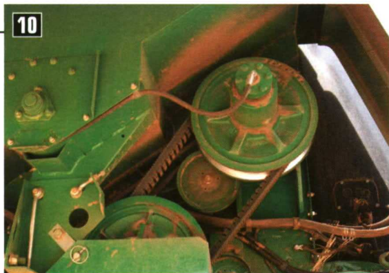
10. Se debe ir provisto de determinadas correas de la transmisión, ya que es frecuente su rotura. Además, son algunos de los componentes que deben ser sustituidos antes de iniciar la campaña, para evitar tiempos muertos. 11. El filtro de aire es uno de los elementos que ha de limpiarse a diario.
