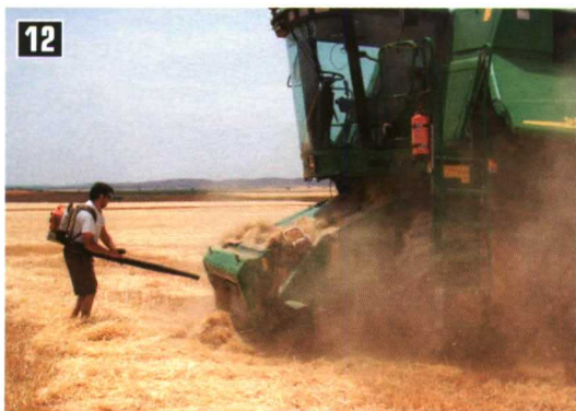
12. Antes de salir a la carretera, es conveniente limpiar la cosechadora con un compresor de aire, para evitar que los restos de paja que quedan adheridos vayan desprendiéndose durante el viaje y así evitar la molestia a otros conductores.
