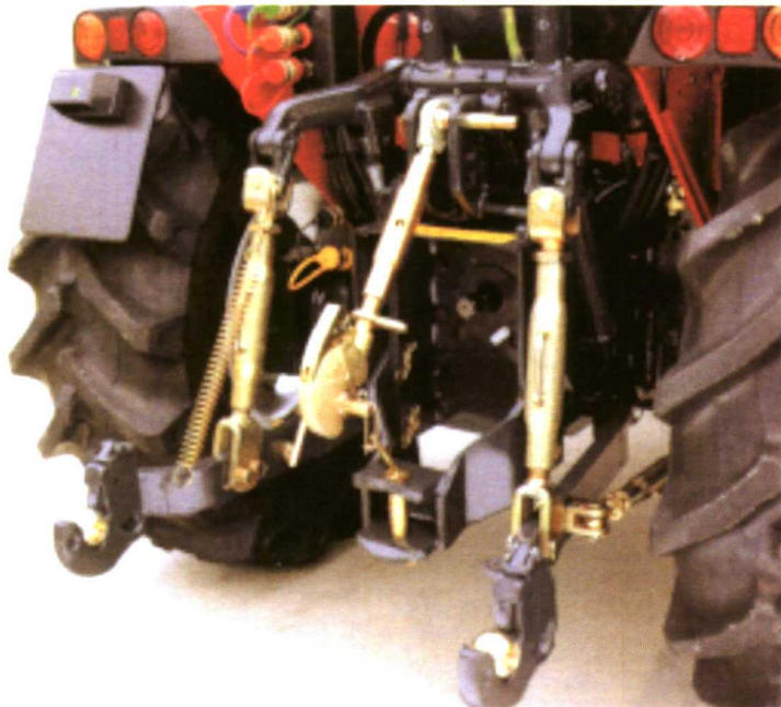
Un elevador trasero, con enganche automático de brazos inferiores, compacto y robusto, con dos cilindros de elevación.
