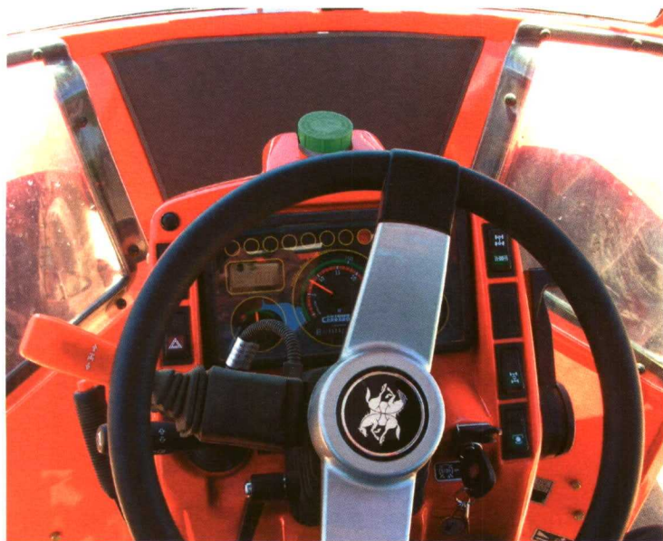
Volante y sistema de aire acondicionado en la parte superior de la cabina.
