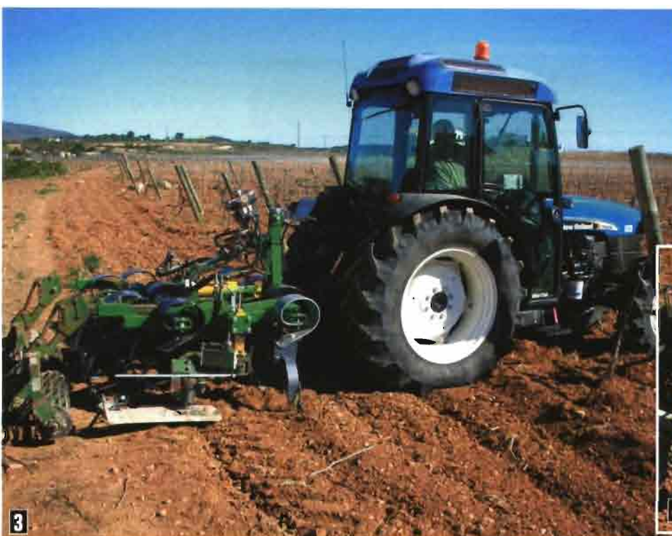
Fotos 3 y 4. A punto de iniciar la labor. Dos aspectos del cultivador con intercepas en cada lado con el que trabajamos.
