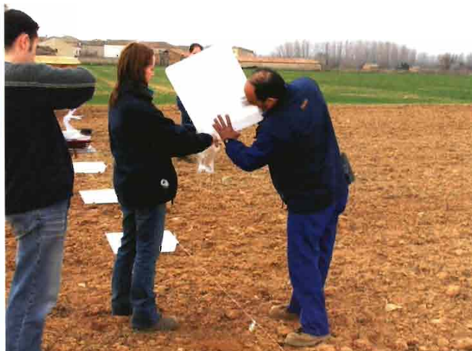
Fotos, de izda. a derecha: esparcido del abono sobre los receptores pasando dos veces para más fiabilidad y comprobación visual del abono recogido.
