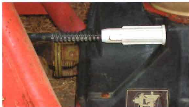
El punto de regulación de la abonadora fue incorrecto por lo que dio la mitad de kilos de lo esperado. Si se regula adecuadamente la máquina da los kilos esperados.
