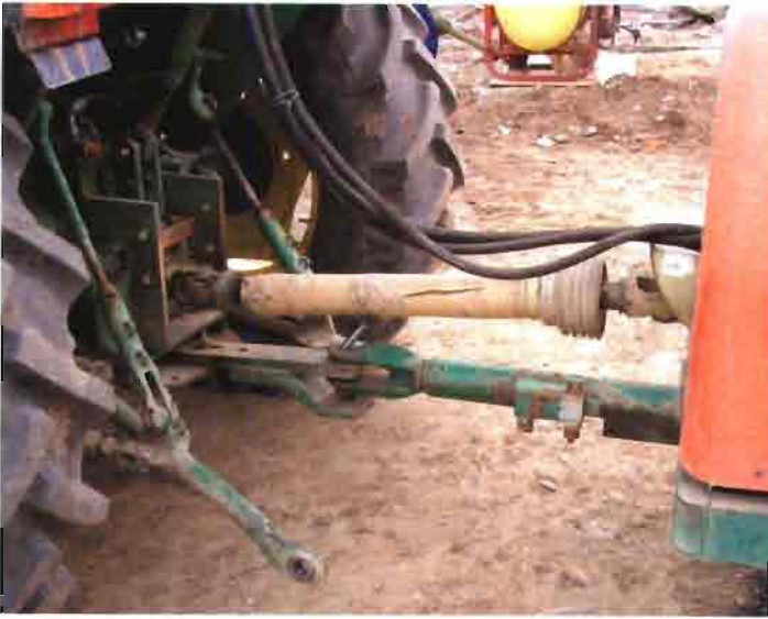
Foto 7. Transmisión de toma de fuerza defectuosa.
