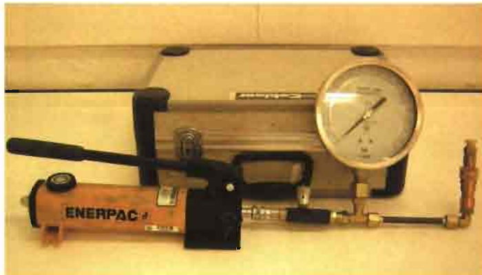
Foto 2. Manómetro de referencia para contraste de presiones.
