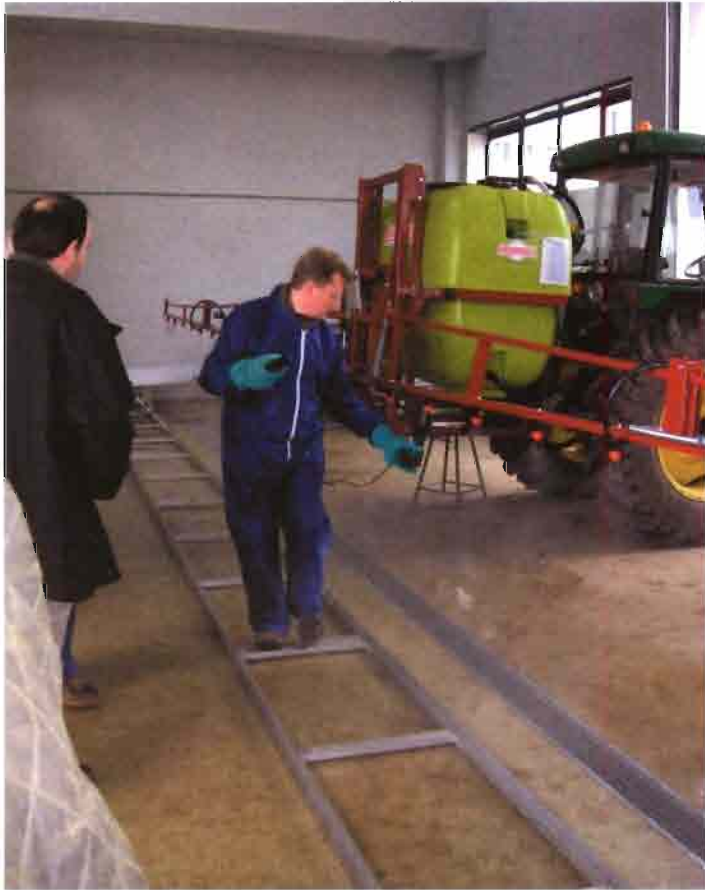
Foto 4. Medición del caudal de boquillas con un caudalímetro electrónico.
