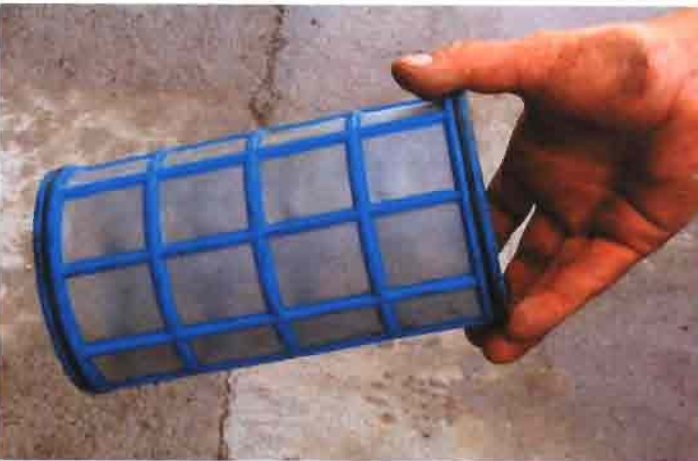
Foto 8. Detalle de filtro en buen estado.
